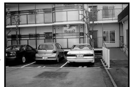
給水方式の変更で撤去された受水槽の跡地に、駐車場の位置をずらし広々とさせた。建物へと続く通路には段差があったので、スロープを設置している。
