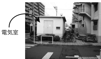
大規模修繕の際に、小型の変圧器に変更(パットマウント方式)し、借室電気室を不要にした。空いたスペースに自転車置場を増設。放置自転車が多く、通るのがやっとだった通路が、すっきりした。
