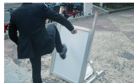
バルコニー一隅で板の蹴破りテストも同時に実施しました。
